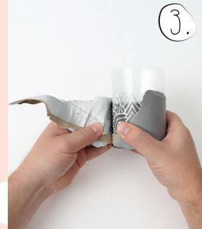
Nach Aushärtung des Betons den Behälter und die Gegenform entfernen.
