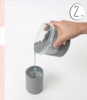
Folie zuschneiden und in einem Behälter mit der Zeichnung nach innen befestigen. Den Beton anmischen und in die Form giessen. Danach eine Gegenform z.B. eine Rechaudkerze aufsetzen und beschweren.
